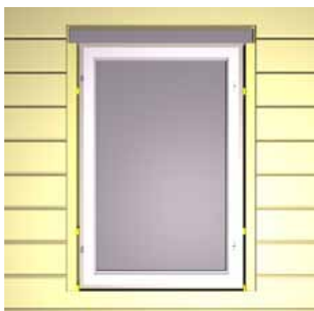
Kuva 8 Ikkuna kiinnitetään karapuihin
