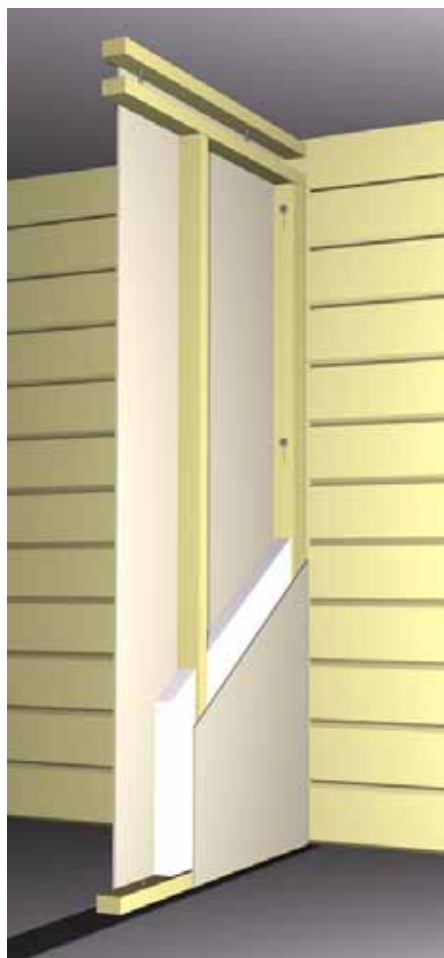
Kuva 11 Esimerkki kevyen runkorakenteisen väliseinän liittämistä hirsiseinään.
